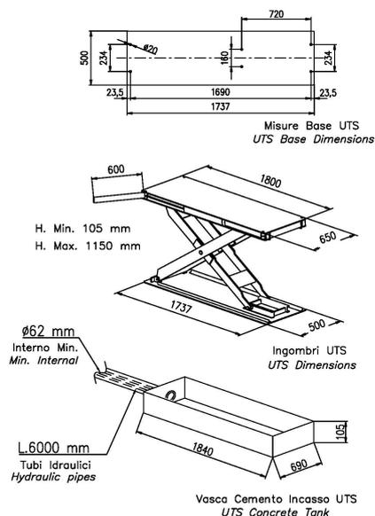
La table de levage **UP TO SHORT** est une solution fine et robuste pour les cabines à peinture, offrant une épaisseur de 11 cm pour les espaces restreints et une capacité de levage de 3000 kg. Fabriquée en Italie, elle garantit durabilité et performance, en conformité avec les normes CE pour une sécurité maximale.
